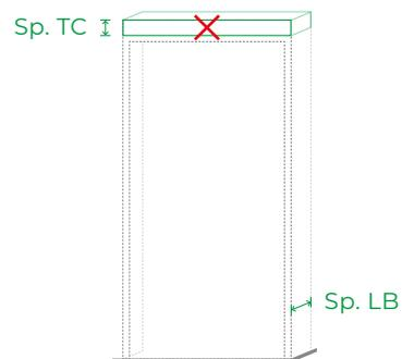
Misura lo spessore muro totale da entrambi i lati e almeno a 3 altezze differenti.
